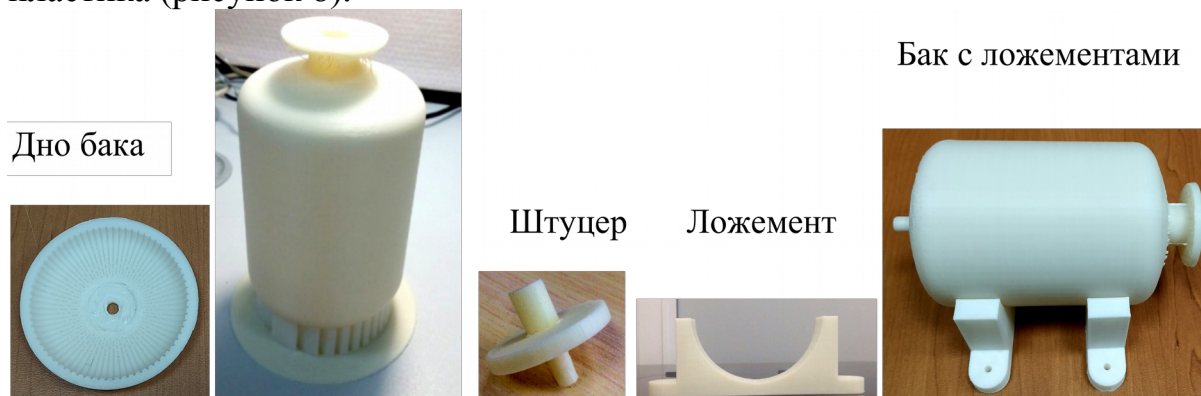
Рисунок 8 – Изготовленные на 3D принтере «Picasodesignerpro 250» из ABS пластика компоненты ДУ
