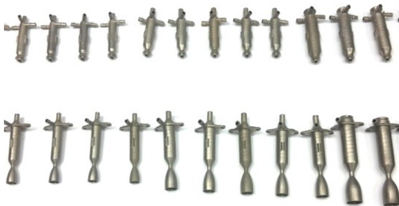
Рисунок 5 - Экспериментальные образцы ЭТМД, изготовленные по аддитивной технологии
