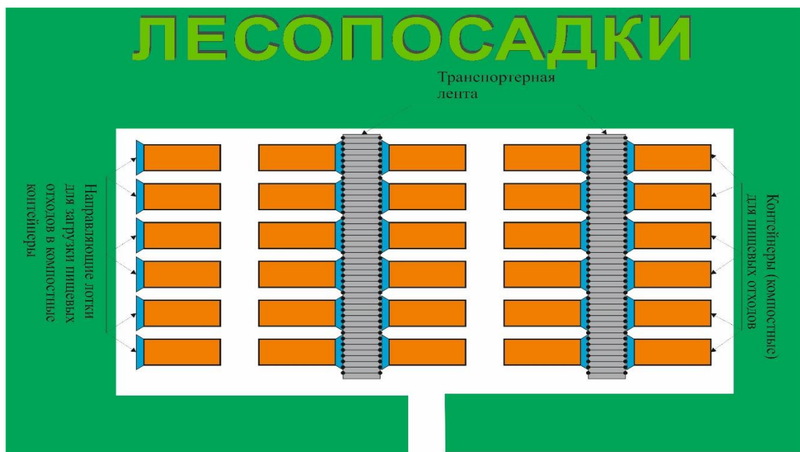
Рис 1. Схема полигона для захоронения пищевых отходов, с целью получения компоста.
