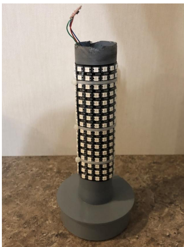
Рисунок 6. Крепление готовой матрицы на корпусе
