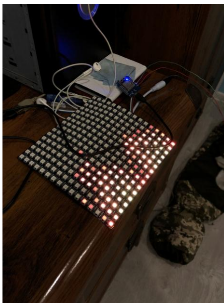
Рисунок 12. Проверка работы кода. Эффект «Огонь».
