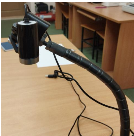
Рис. 12. Веб-камера A4TECH модели РК-910Н на магнитной стойке
