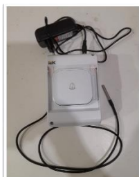
Рисунок 5. Действующий макет электронного термометра для людей с ограниченными возможностями по зрению.
