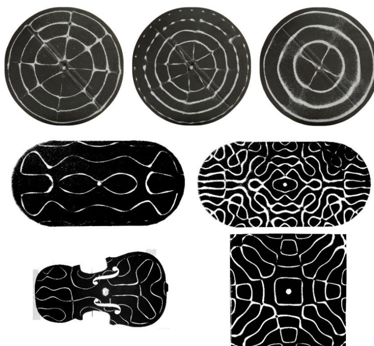
Рисунок 7 - Круглые пластинки Хладни, демонстрирующие свойства интегрируемых бильярдов
