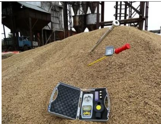
Отбор пробы из массы зерна на токе
