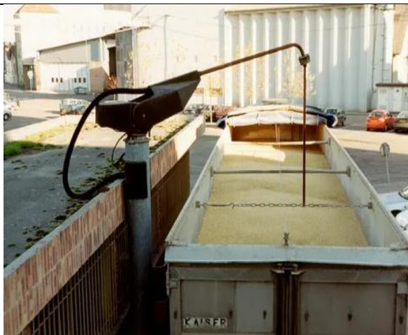
Отбор пробы из массы зерна с транспорта
