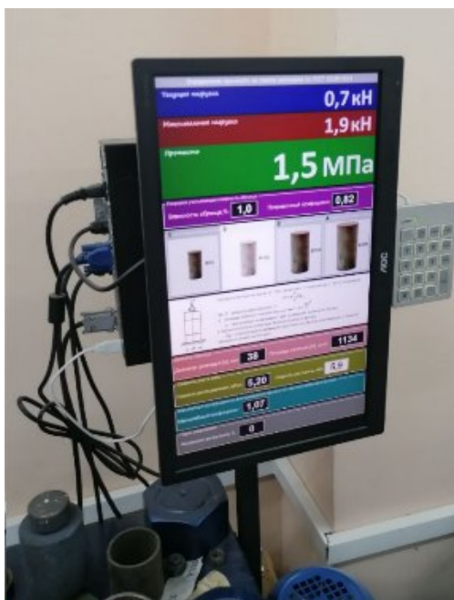
Рисунок 5 – Испытание цемента на прочность
